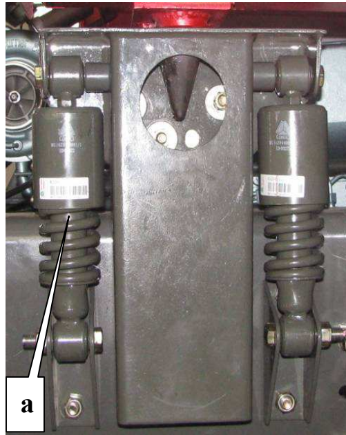
Рис. 3-6 (а) Амортизатор (спиральная пружина)
