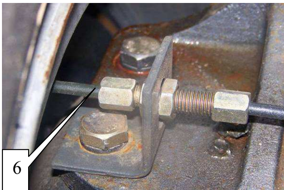
Водопроточная труба переднего вала
