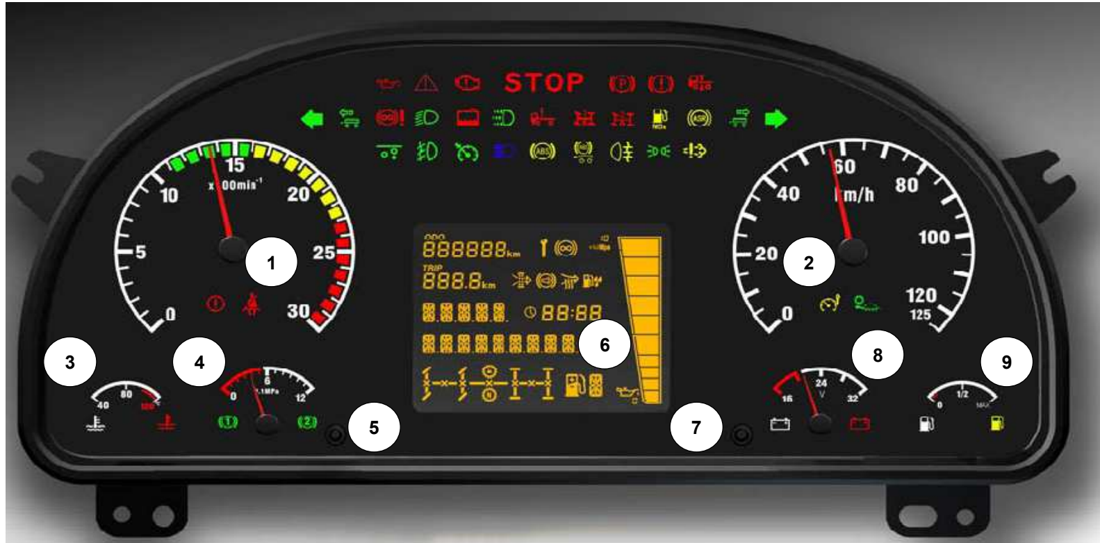
1. указатель скорости оборотов двигателя 2. указатель скорости автомобиля 3. указатель температуры воды двигателя 4. указатель воздушного давления 5. шпонка 2 6. экран показания кода участка 7. шпонка 1 8. указатель напряжения 9. указатель топлива
