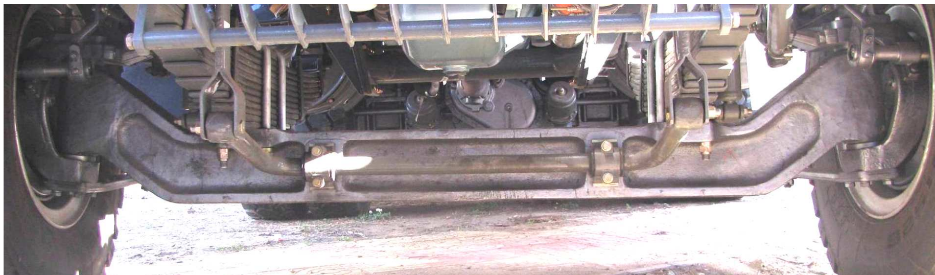
Рис. 5-3 схема внешнего вида переднего вала HF12
